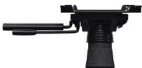
Mecanismo SYNCRO Con Slido 1. Ajuste de altura. 2. Reclinación sincronizada 3:1 de respaldo y asiento con bloqueo en diferentes posiciones. 3. Ajuste de la profundidad del asiento. 4. Perilla para ajustar la suavidad de la reclinación. 5. Sistema Antishock para que el respaldo no regrese de golpe.
